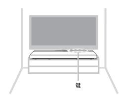
将条形音箱安装在电视机底座等位置。
