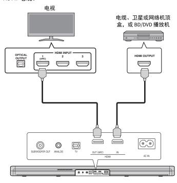
如果要连接支持音频回传通道(ARC)的电视,当如上所示进行连接时条形音箱仅可以播放电视的音频。
